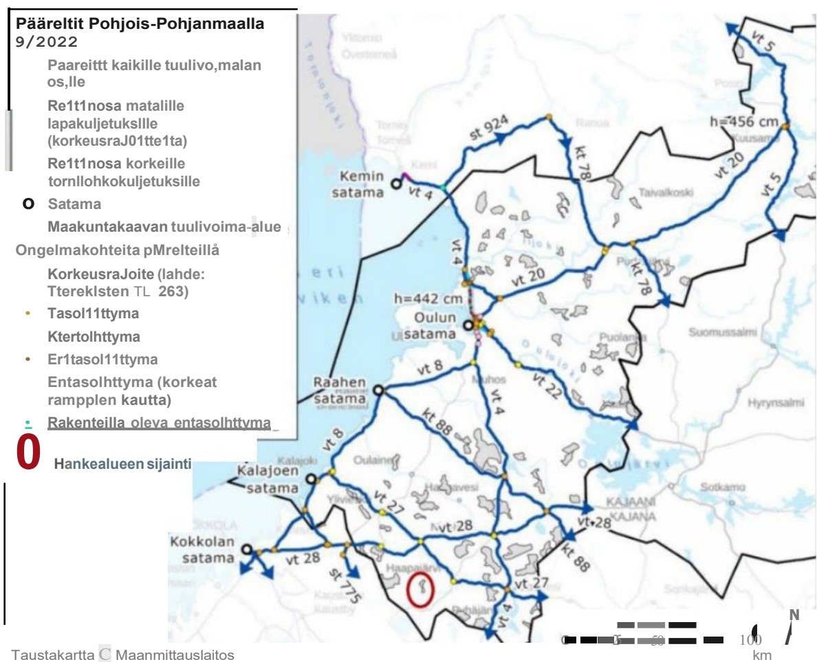
Kuva 31. Tuulivoimakuljetusten pääreitit ja mahdollisia ongelmakohteita Pohjois-Pohjanmaan länsiosassa (Liikenteellinen saavutettavuusselvitys, A-Insinöörit; muokattu lähteestä Laitinen ym. 2022).
